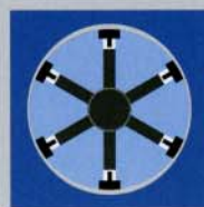
Ermittlung des mittleren Durchmessers mit kontaktloser Pneumatischer Messung
